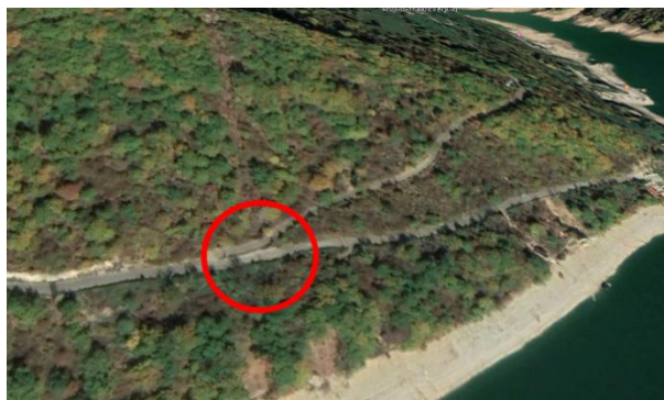
Slika 40. Pozicija kameno-blatnog toka koji je aktivirao klizno tijelo ispod puta
