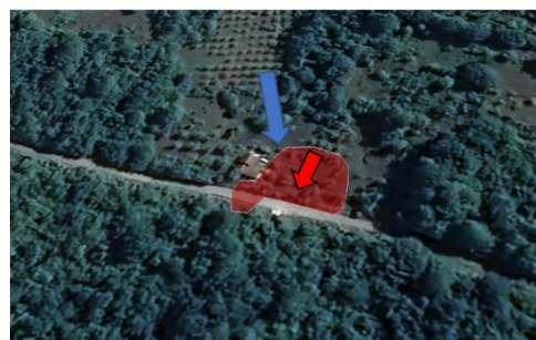
Slika 44. Pozicija kliznog tijela, smjer kretanja i dotok vode
