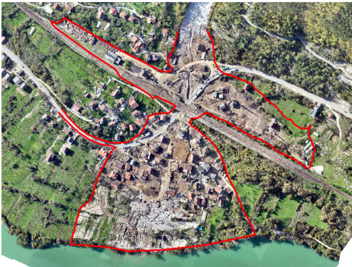
Slika 53. Prikazana je dvostepena lepezasta depoziciona zona debrinskog toka u naselju Donja Jablanica. Prvi segment lepeze nalazi se iznad željezničke pruge, sa maksimalnom širinom od 560 metara. Željeznička pruga na nasipu djeluje kao fizička barijera i usmjerava tok prema podvožnjaku koji se nalazi tačno na centralnoj liniji toka, omogućavajući prolaz ispod pruge za magistralnu cestu M17. Drugi segment lepezaste zone počinje ispod podvožnjaka, gdje se tok ponovo širi i formira sekundarnu lepezu koja se proteže prema rijeci Neretvi, dostižući približno 350 metara širine na mjestu prelaska u rijeku.
