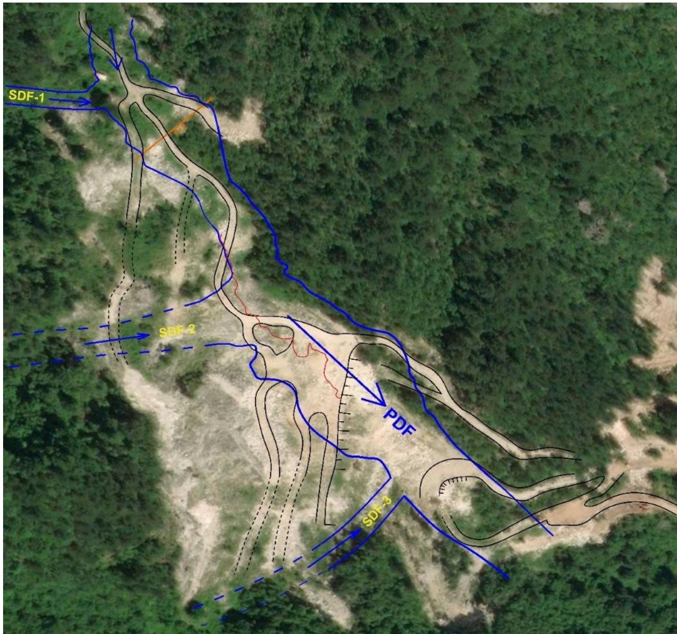
Slika 34. Mapa debitnih tokova u zoni kamenoloma (PDF i SDF-1, SDF-2, SDF-3) i pristupnih puteva prema snimku s platforme BING. Napomena: Snimak možda ne odražava posljednje stanje terena prije katastrofe
