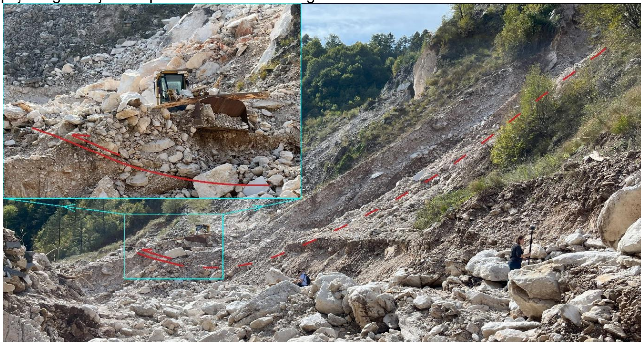
Slika 35. Hidraulički slom sipara na mjestu spajanja primarnog debritnog toka (PDF) i drugog sekundarnog debritnog toka SDF-2
