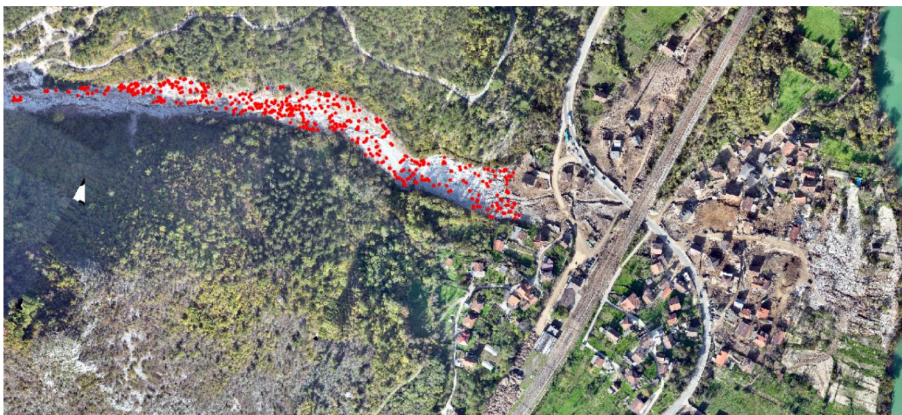
Slika 42. Prikaz distribucije tehnogenih blokova duž elongirane depozicione zone, označenih crvenim tačkama, koji su transportovani tokom kretanja recentnog debrinog toka. Ova mapa jasno pokazuje kako su blokovi, porijeklom iz kamenoloma, premješteni i deponovani duž toka sve do naselja
